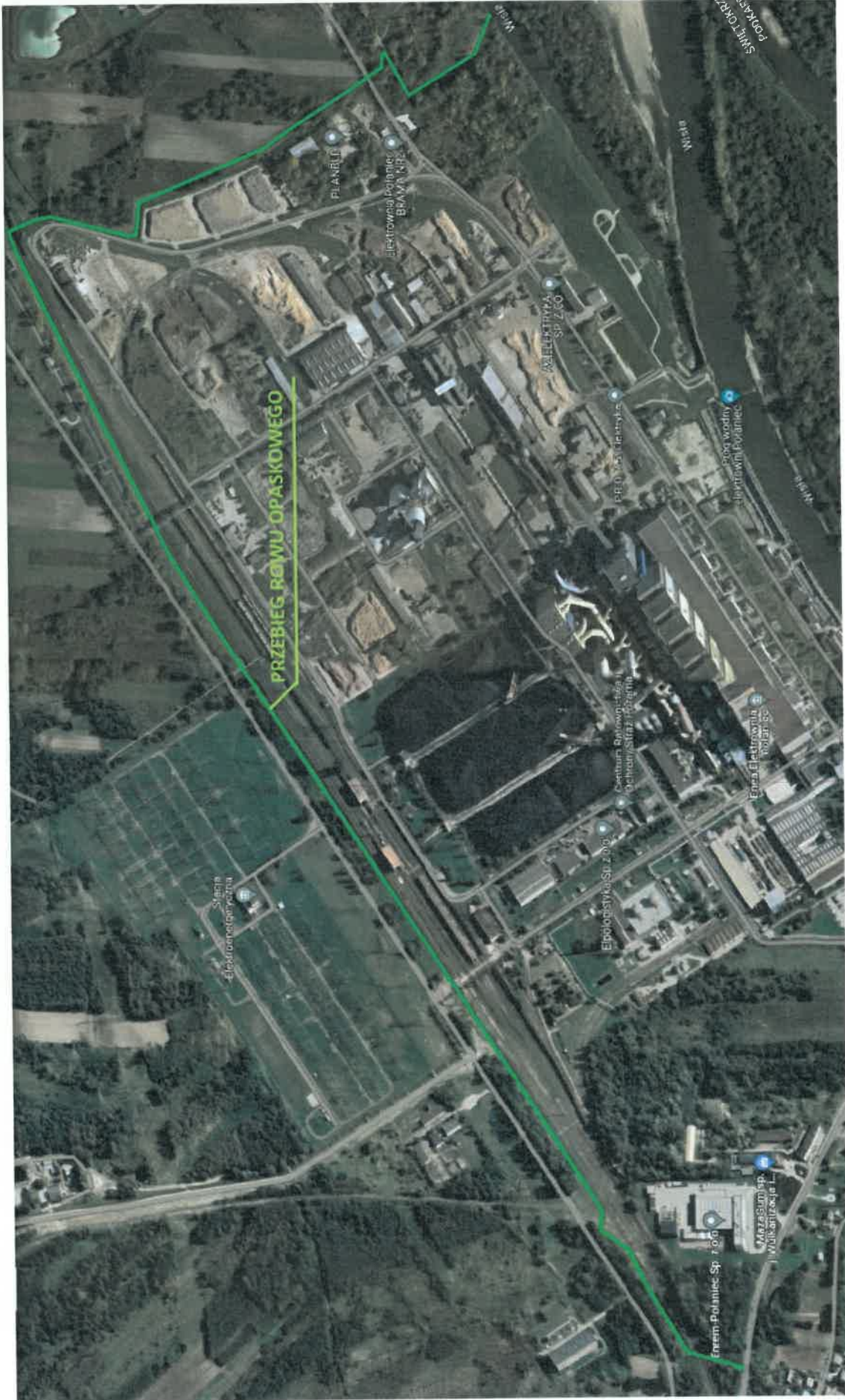
Rys. 2. Przebieg rowu opaskowego elektrowni
